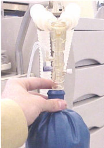
Conecte firmemente um balão de teste de 500mL na peça "Y".
