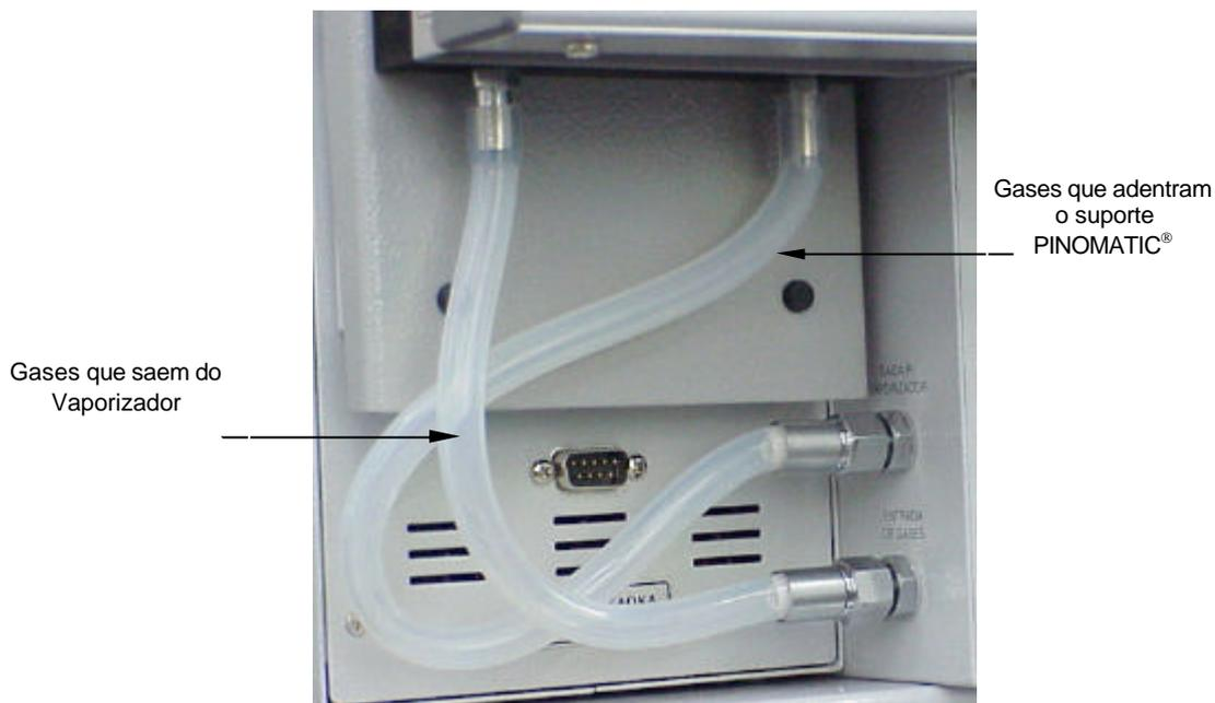
Figura 7-1: Ligação entre Rotâmetro e Vaporizador
