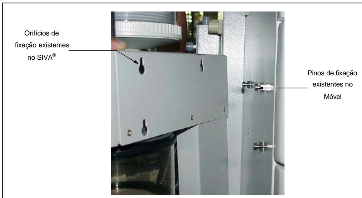
Figura 7.8: Fixação do SIVA® no Móvel do Aparelho de Anestesia
