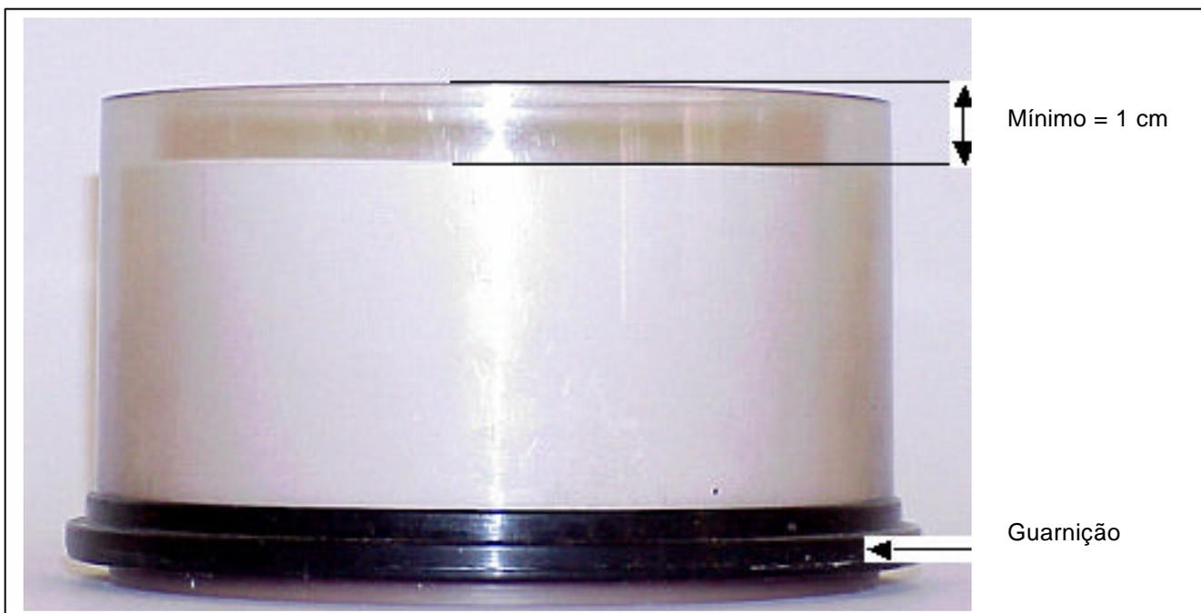
Figura 6.12: Nível Máximo de Cal Sodada
