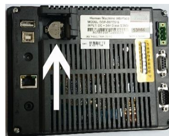
Figura 2 - Compartimento da bateria aberto
