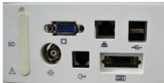
Figura 17 - Conectores do Monitor LiFEtouch M15
