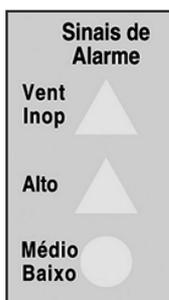
Os Sinais luminosos agrupam-se na parte superior direita do painel dianteiro. Há três LEDs. O superior se acende com luz vermelha quando um alarme de alta prioridade é ativado. O sinal da posição média pisca de maneira intermitente com luz amarela quando o evento for de prioridade média, e se acende de maneira permanente quando o evento tem uma prioridade baixa.
