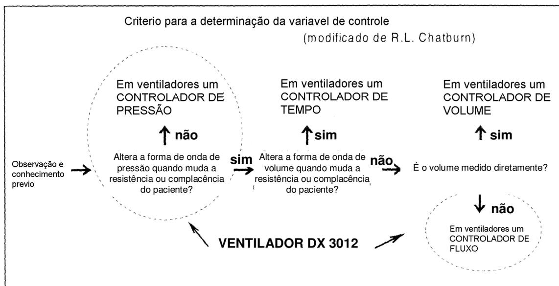
De acordo com esse conceito, o ventilador **DX 3012** é um controlador de pressão ou de fluxo. A inspiração tem disparo por pressão, fluxo, tempo ou manualmente. É limitado por pressão, volume ou fluxo e ciclado por pressão, volume, fluxo ou tempo. Tem incorporado um misturador ar-oxigênio integral. Em ventilação não-invasiva, tem capacidade de compensação de fuga de até 50L/min em categoria ADL, 30L/min em PED e 10L/min em NEO/
