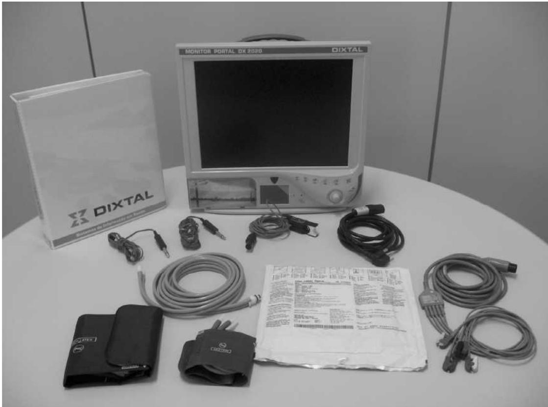
Figura 39: Visão das partes que acompanham o monitor.
